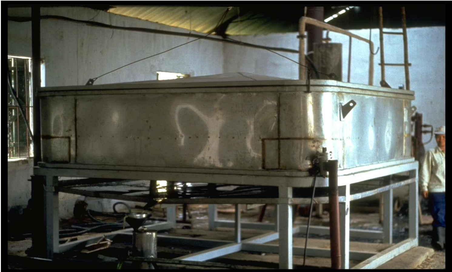
Foto: Vietnam 1995 – loc. “Donganh Distillatore Concetto “in orizzontale” del sig. Thierry Aldeghe Per la distillazione in corrente di vapore ottimizzato del basilico.
